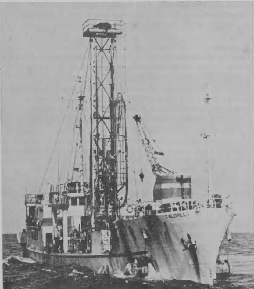
CALDRILL I holds a computer-controlled position while drilling core holes in water 4350 feet deep in the Gulf of Mexico off Texas. CALDRILL I ta mantene un posicion controlá pa computador, durante e boramento den awa na un profundidá di 4,350 pia den Golfo di Mexico cerca di Texas.
